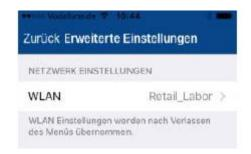
Klicken Sie hier auf den Menüpunkt *WLAN* (iOS) oder *WLAN Netzwerk verwalten* (Android). Wählen Sie nun Ihren Router aus und hinterlegen Sie Ihren WLAN Schlüssel. (Hinweis: die Akku Kamera kann nur mit WLAN Schlüssel bis maximal 31 Zeichen arbeiten.)
